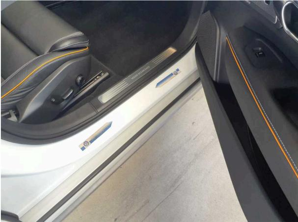
**Beschädigung 3:** Schweller rechts: Einstieg - Kratzer - Smart Repair
