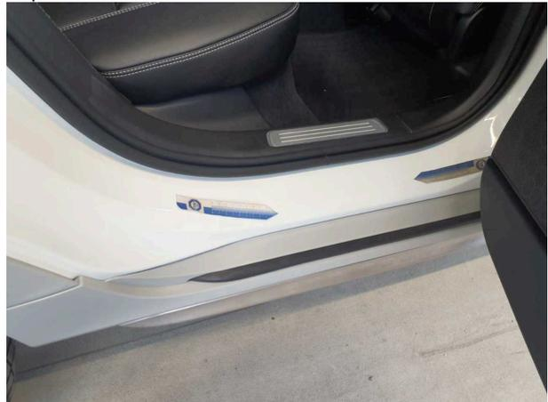
**Beschädigung 4:** Seitenwand rechts: Einstieg - Kratzer - Smart Repair
