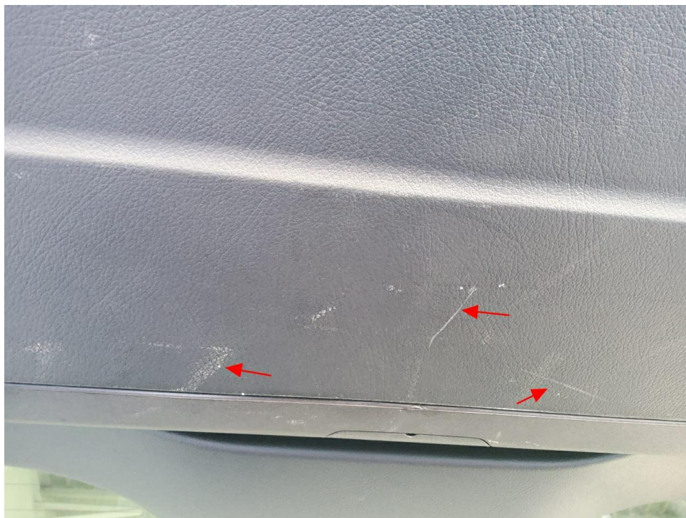
Bild 7 : Verkleidung Heckklappe verschrammt
