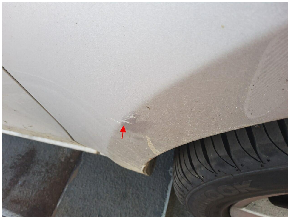
Bild 10 : Kotflügel vorne rechts verschrammt
