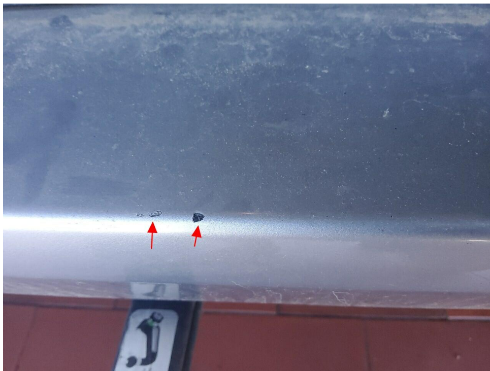
Bild 8 : Stoßfänger hinten verschrammt
